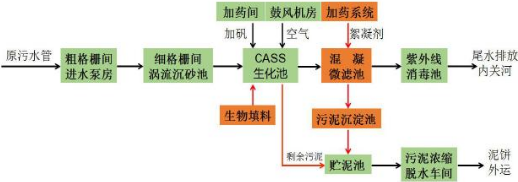
图4-3. 潮安区污水处理厂处理工艺
