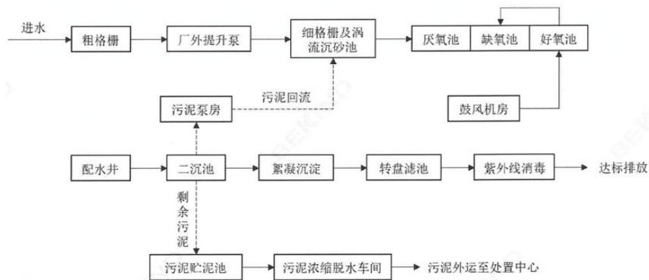
图4-1. 沙溪污水处理厂污水处理工艺流程图
