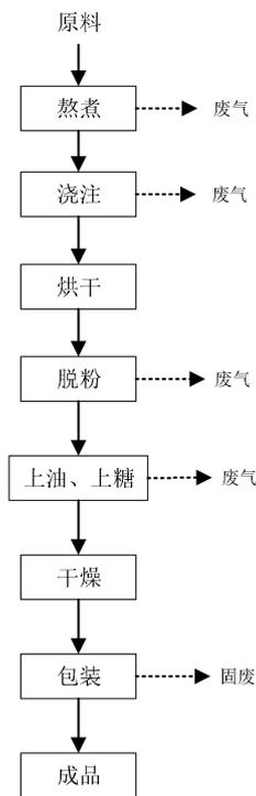
图2-1. 本项目生产工艺流程图
