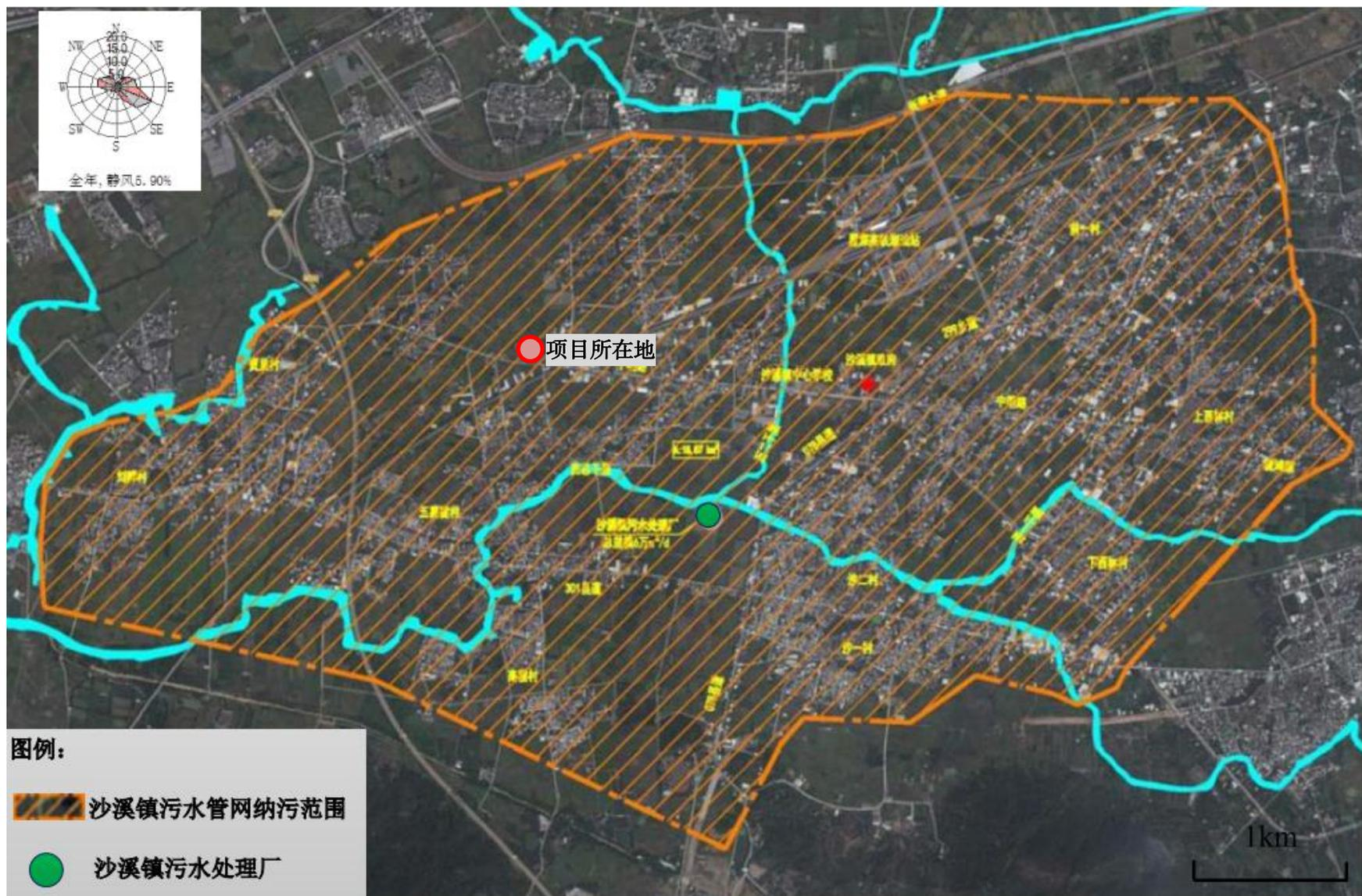
附图 13 沙溪污水处理厂纳污管网示意图
