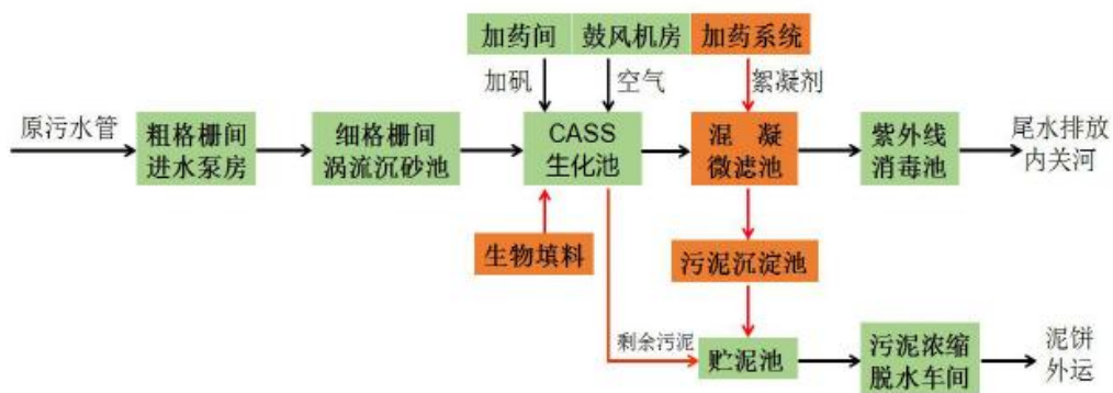
图4-1 潮安区污水处理厂处理工艺
