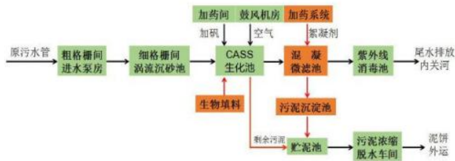
图 4-2 潮安区污水处理厂处理工艺
