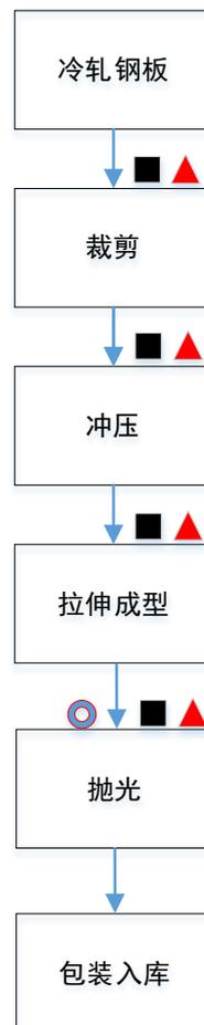
图 2-3. 本项目不锈钢制品生产工艺流程图
