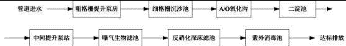
图 4-2 潮州市第一污水处理厂的处理工艺流程图
