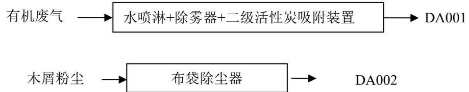
图 4-1 废气处理工艺流程图
