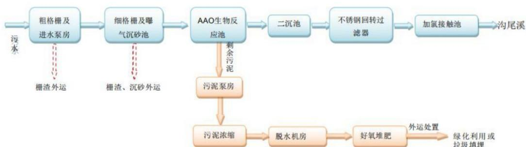
图 4-2 潮州市第二污水处理厂处理工艺流程图
